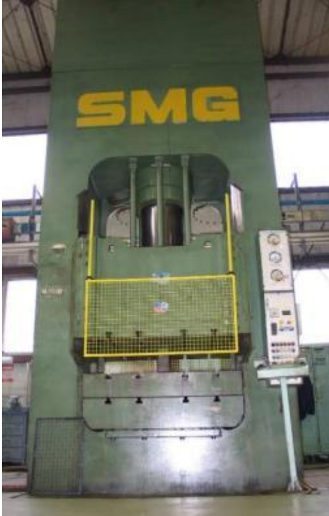
SMG hydraulic press -force up to 400 MPa
